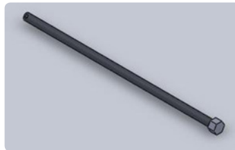
Figura 8.8 – Parafuso do suporte da roda da frente
