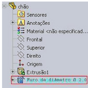
Figura 5.5 – Selecionando o recurso para o Padrão linear na Árvore da peça
