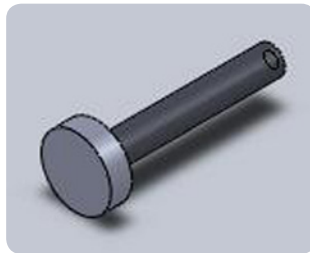
Figura 8.12 – Parafuso da guia da chapinha da direção
